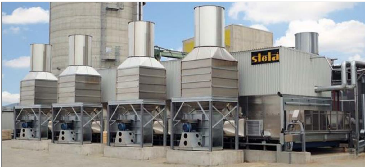
3.3.9 pav. Preliminari juostinės džiovyklos vizualizacija.
