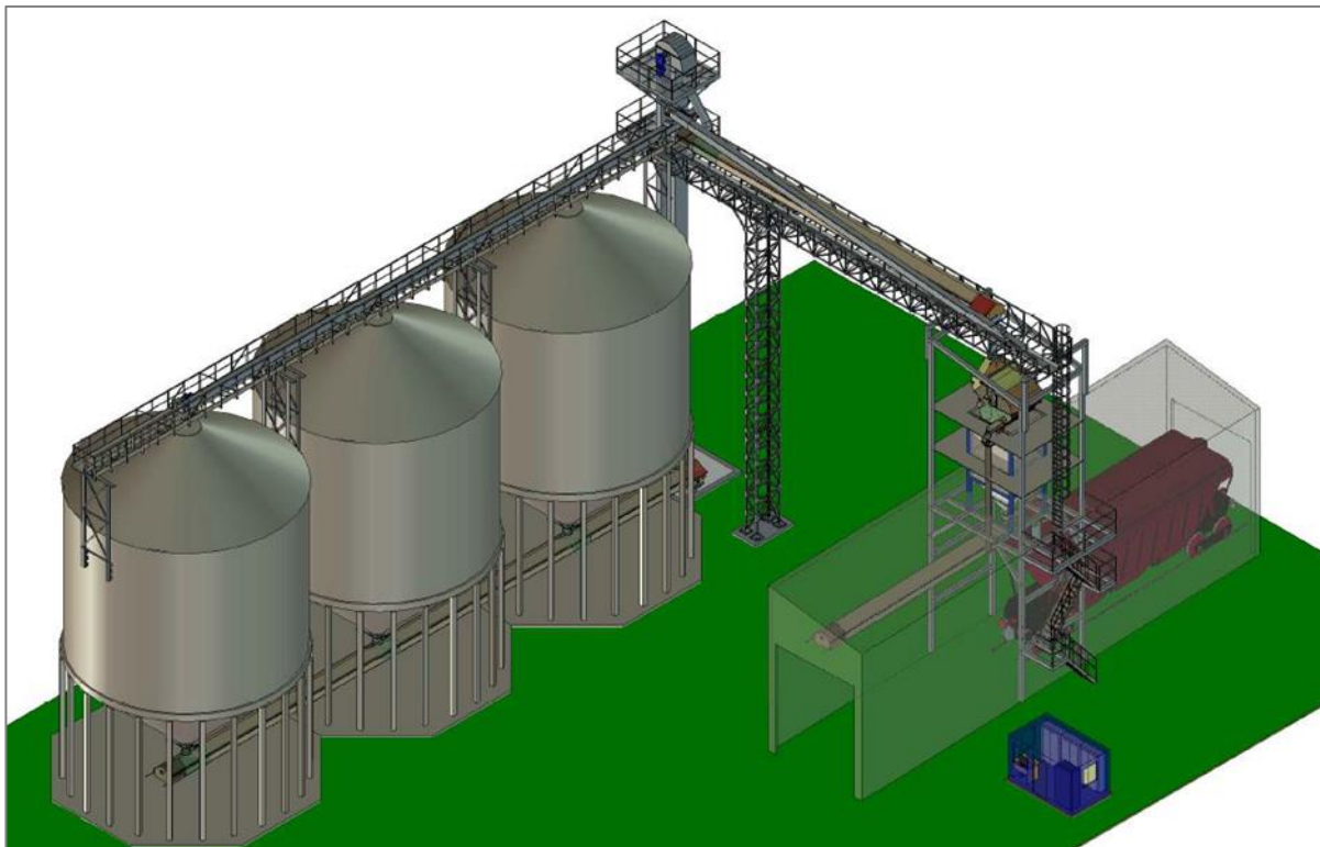
3.3.16 pav. Preliminari silosų ir pakrovimo mazgo vizualizacija.
