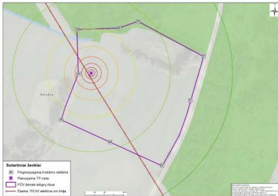
5.3.2 pav. Prognozuojamas vėjo elektrinių ir transformatorinės triukšmas.
