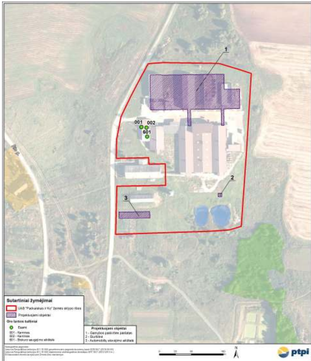
5.1.1. pav. UAB „Padvaiskas ir Ko“ oro taršos šaltinių schema.
